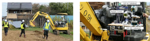
図 3. 模擬施工空間 (左図) ・建機搭載 LiDAR (右図)
