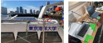
図 2-1 らいちょうに設置した GNSS アンテナ・受信機
