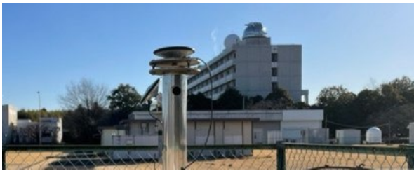
第 1 図 気象研究所露場の GNSS アンテナ
