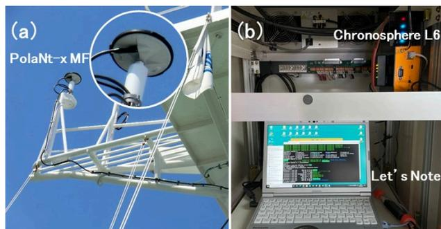
図 1 (a) 啓風丸レーダーマストに設置した GNSS アンテナ、(b) 船内の GNSS 受信機と解析用 PC
