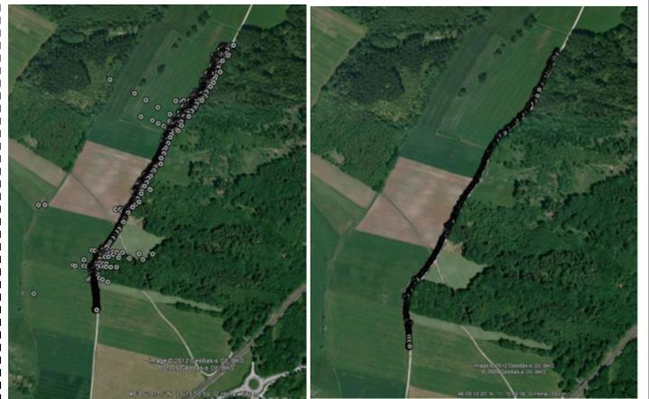
写真-6 単一アンテナ(左)と、アレイアンテナ(右)による測
