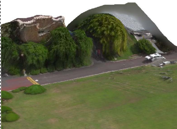
簡易的な写真測量で得られた3次元モデル
