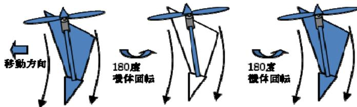
図3 自転式自律飛行体の位置制御の原理
