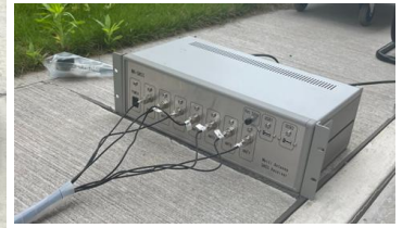
図 3 マルチ受信機システム MA-GNSS (汎用受信機 7 台内蔵)
