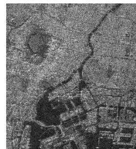
図 2 パウリ分解結果 (一回反射)
