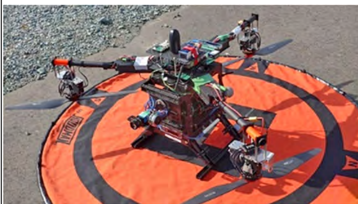
図5. 屋内外シームレス測位機能を搭載した UAV（トライコプタ）
