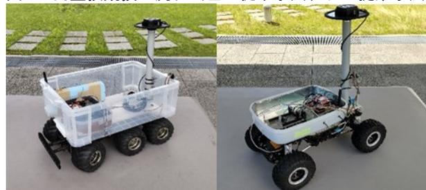
図2 車体の外観(左:6輪車体、右:4輪車体)
