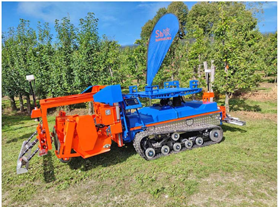
図 6 スロベニア PEK Automotive 社の大型果樹園や葡萄畑向けの汎用型ロボット、 本文 P.5 FIRA 参加報告より
