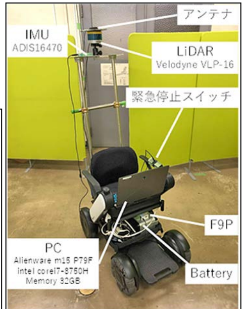
研究で使用している電動車いす (WHILL)。自律移動も可能であるため、様々な用途のプラットフォームとして活用
