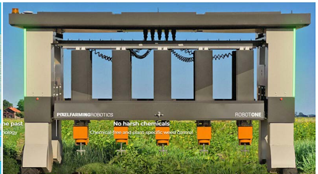
図1 オランダ Pixel Farming Robotics社の Robot One ロボット、野菜畑むけの除草 ロボット・本文P.4 FIRA参加報告より
