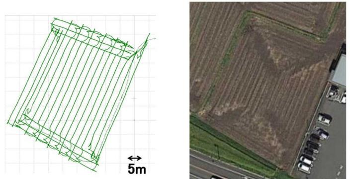
図4. 参照用後処理RTK測位結果 右はほ場の航空写真
