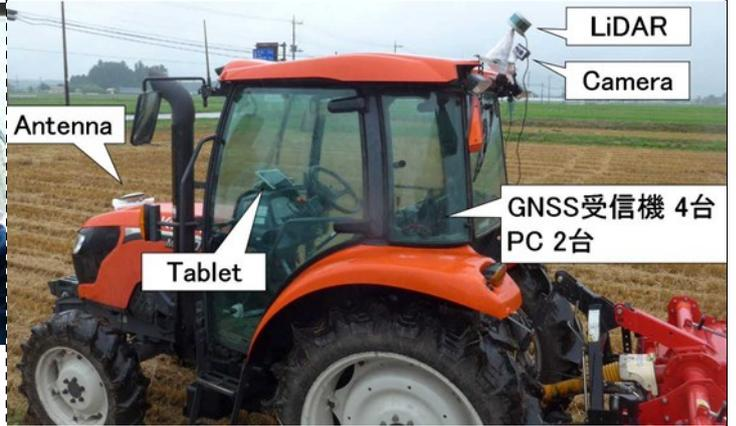
図3. トラクターに設置した機器の配置
