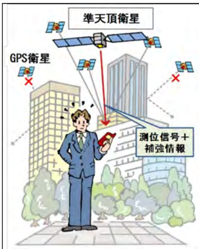
図2 準天頂衛星によるGPS衛星の補完と補強
