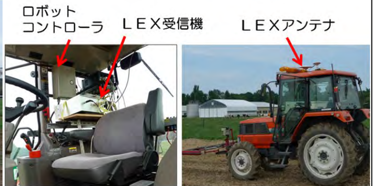
図3 準天頂衛星初号機による農作業のロボット化実証実験
