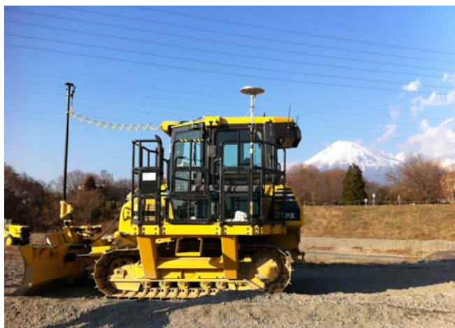
みちびきのcm級測位補強をブルドーザによる整地作業に適用(日本建設機械化協会施工技術総合研究所での実証実験の様子: P.3 参照)
