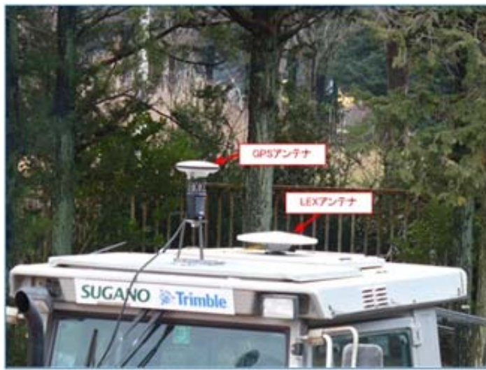
「みちびき」民間利用実証 農機に搭載したみちびきLEX信号受信機材(農村工学研究所にて P.3参照)
