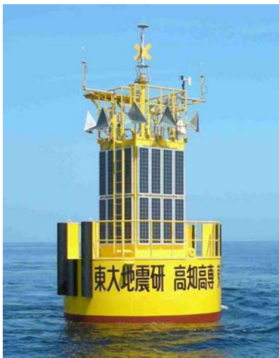
図2：高知県室戸市沖に設置されているGPS津波計。中央のポールの先端にGPSアンテナが設置されている。
