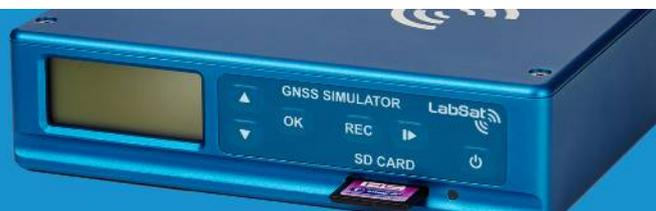
LabSat3 は実際の衛星信号の記録・再生を行うことができます。記録されるデータは、マルチパスや障害物の影響・大気の影響などを受けているその時の実際の衛星信号です。衛星数の制限もなく、その時にあるすべての衛星信号が記録されます。
