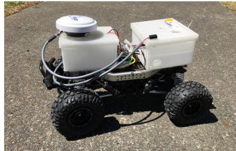
図1 GNSS ロボットカー外観
