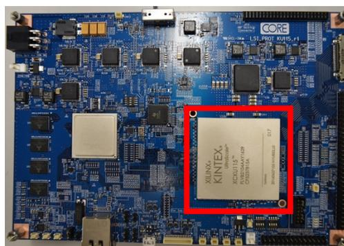
図2:LSI評価用FPGA基板(赤枠がLSI相当)
